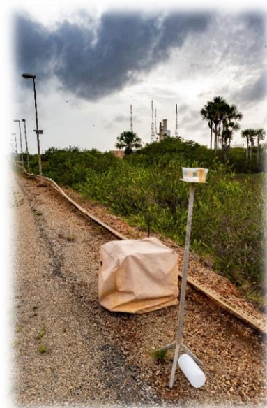
Figure 1 : Bac à eau sur son trépied métallique et SPM Honeywell sur le chemin de ronde
