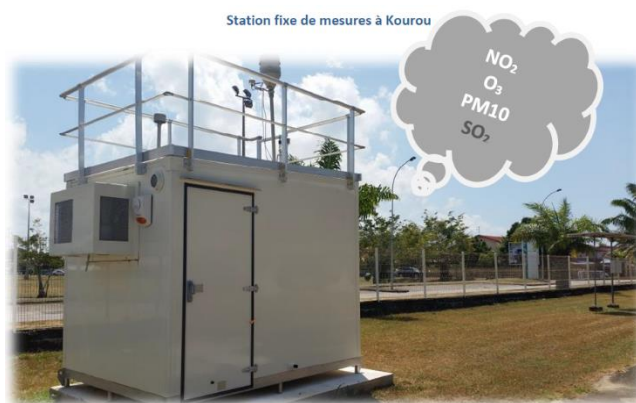
Figure 6 : Station de surveillance BRADY à Kourou, 2015
